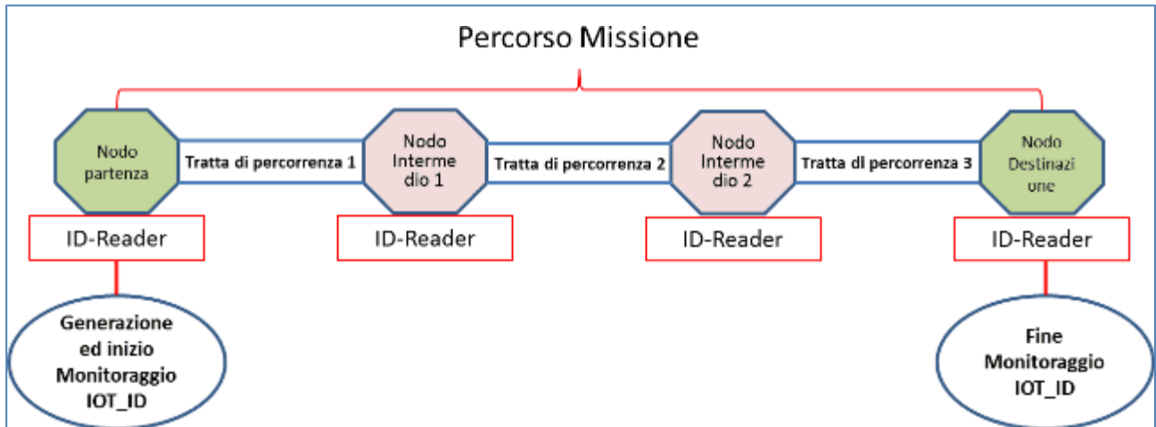
Figura 8: elementi identificativi del tracciamento logistico
