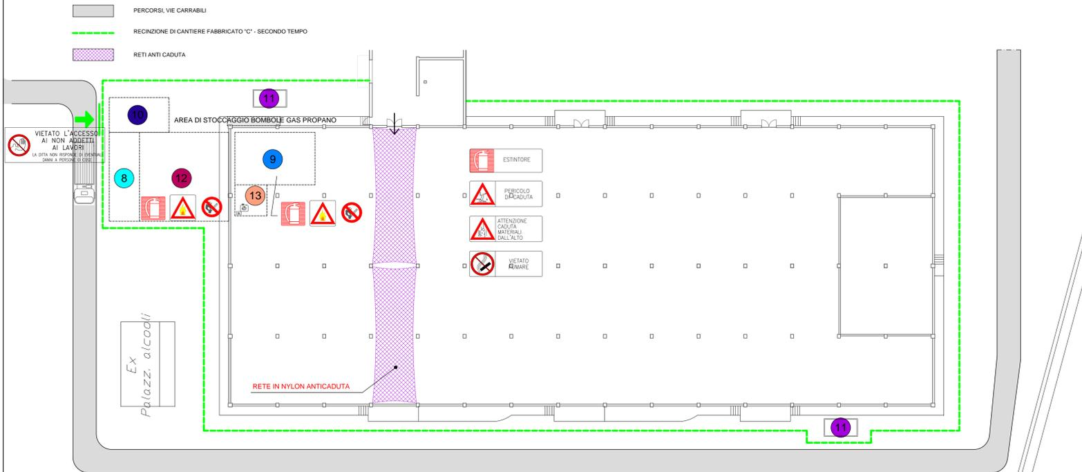
N.B. LE OPERAZIONI DI SCAVO PER CANALIZZAZIONE DEGLI IMPIANTI DOVRANNO COMUNQUE GARANTIRE L'ACCESSIBILITA' CARRABILE A TUTTI GLI EDIFICI.
